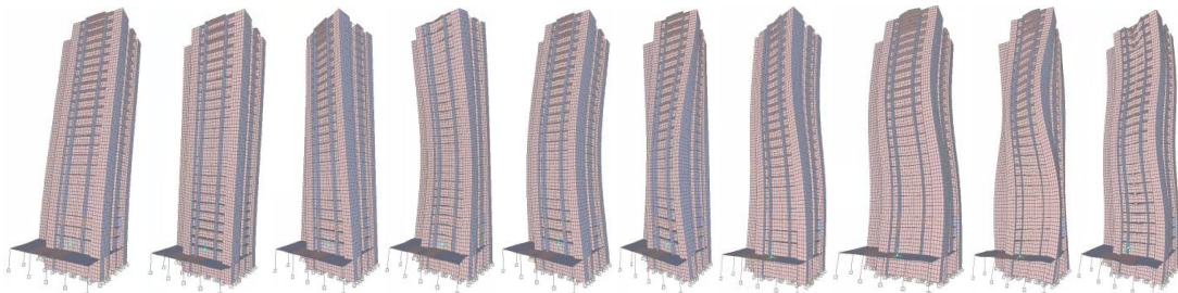
(a) f_1=1.334\text{Hz} ; (b) f_2=1.487\text{Hz} ; (c) f_3=1.980\text{Hz} ; (d) f_4=5.057\text{Hz} ; (e) f_5=5.110\text{Hz} ; (f) f_6=6.178\text{Hz} ; (g) f_7=10.014\text{Hz} ; (h) f_8=10.457\text{Hz} ; (i) f_9=11.183\text{Hz} ; (j) f_{10}=11.183\text{Hz}
