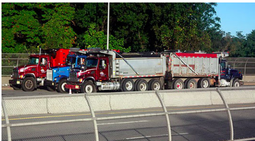
图4 六台卡车静载试验
