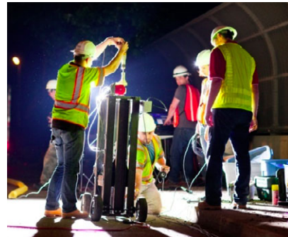
(b) 落锤脉冲锤击法实验
