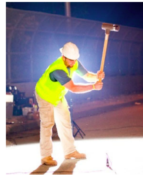
(a) 手锤脉冲锤击法实验
